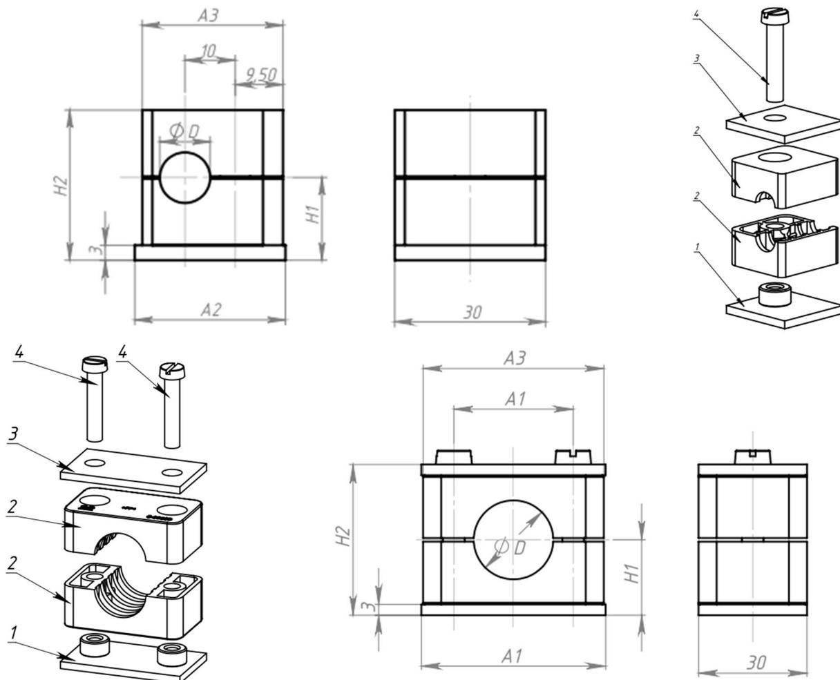
1. приварная площадка, 2. трубный зажим, 3. прижимная пластина, 4. винт
