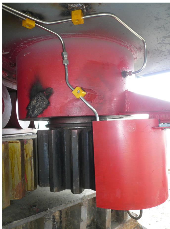
крепление трубопроводов системы смазки
